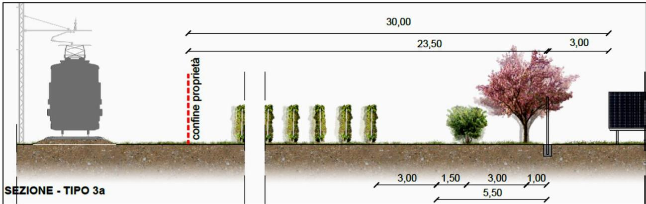
*Sezione schematica della mitigazione (Tipo 3a)*
